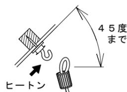
・必ずヒートンの開口部が上を向くように取り付けしてください。
