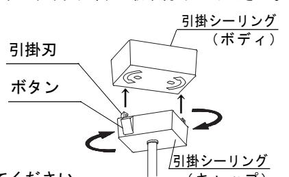
3 フランジを取り付けてください。フランジは引掛けシーリングがかかるように押し上げ天井に密着させてください。
