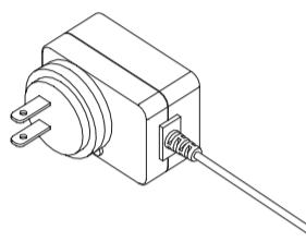
x1 スイッチを押しながら、電源ユニットをコンセントをに差し込んでください。LEDが1回光ります。スイッチは押したままにしてください。
