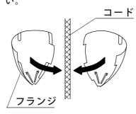
ボタンを押し、そのまま左方向へまわしてください。 \_\_\_'\_\_(キャップ) フランジを取り付けてください。フランジは引掛シーリングがかくれるように押し上 げ天井に密着させてください。 (図1参照)
