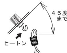
●必ずヒートンの開口部が上を向くように取り付けてください。
